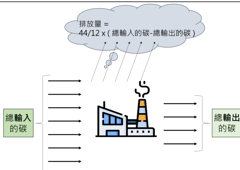
圖 2-5、質量平衡法計算示意圖
